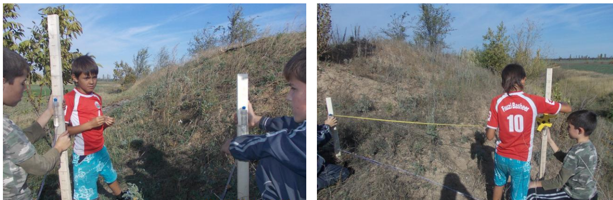
Рис. 17. Вимірювання профілю з використанням гідронівеліра
